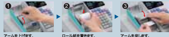
①アームを上げます。 ②ロール紙を置きます。 ③アームを戻します。
